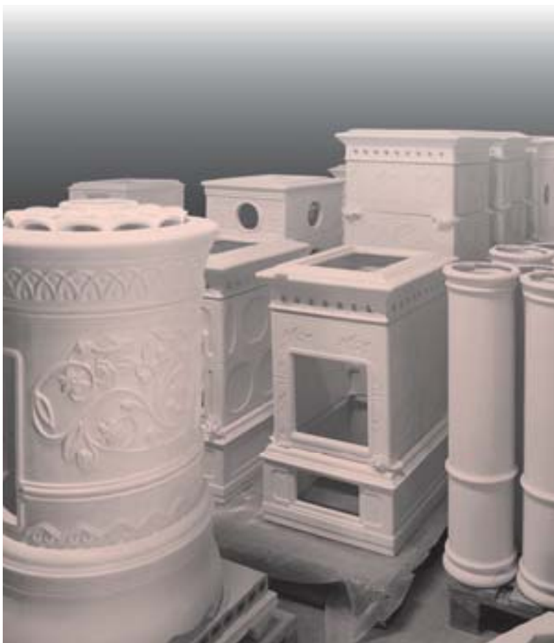
Semilavorati di stufe in materiale refrattario bianco. La Castellamonte 2007
